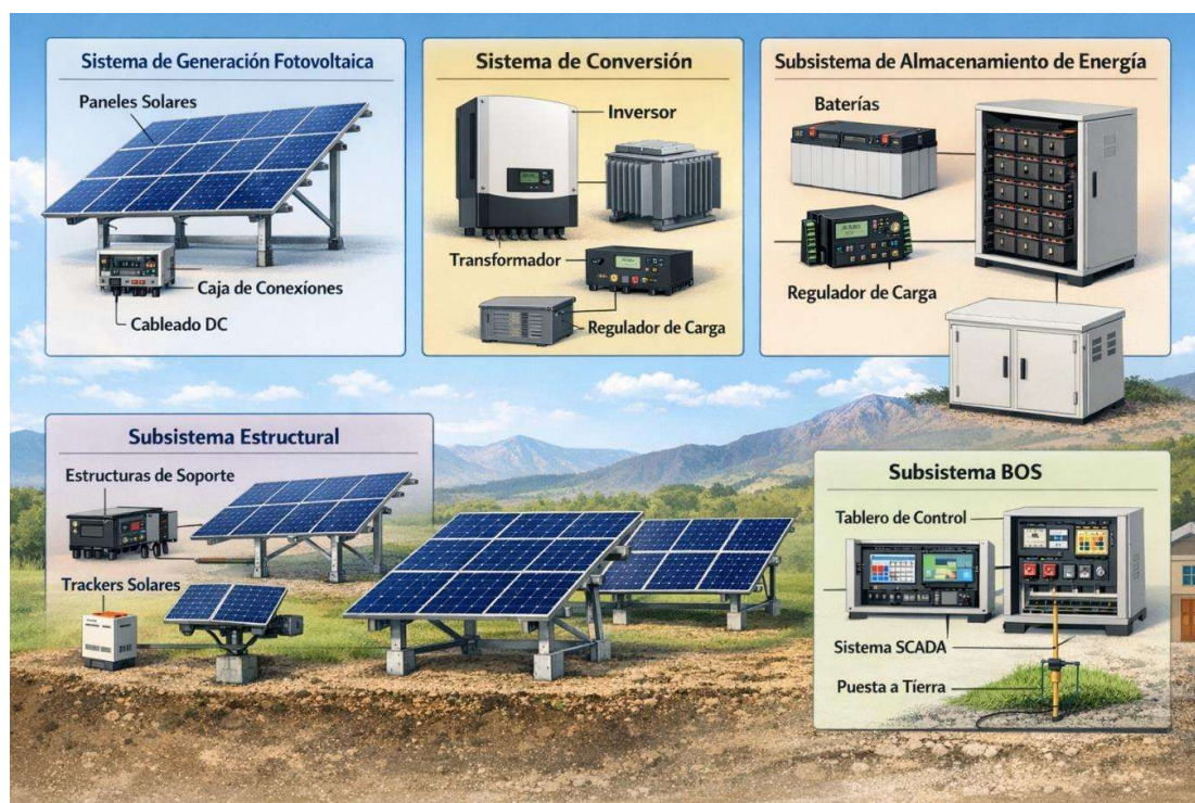
Figura 1. Componentes de los sistemas fotovoltaicos
